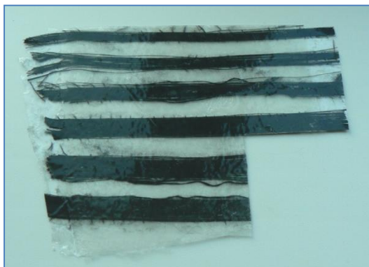
Рис. 6 Образцы углепластика, который мы получили
