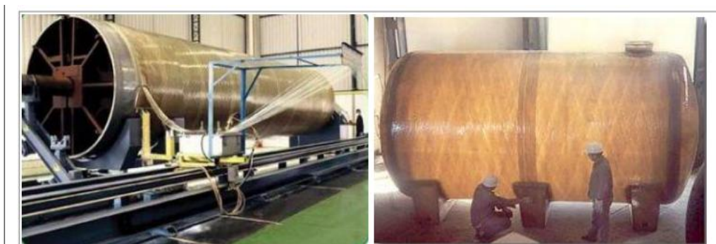
Рис. 7 Изготовление стеклопластиковых ёмкостей способом намотки
