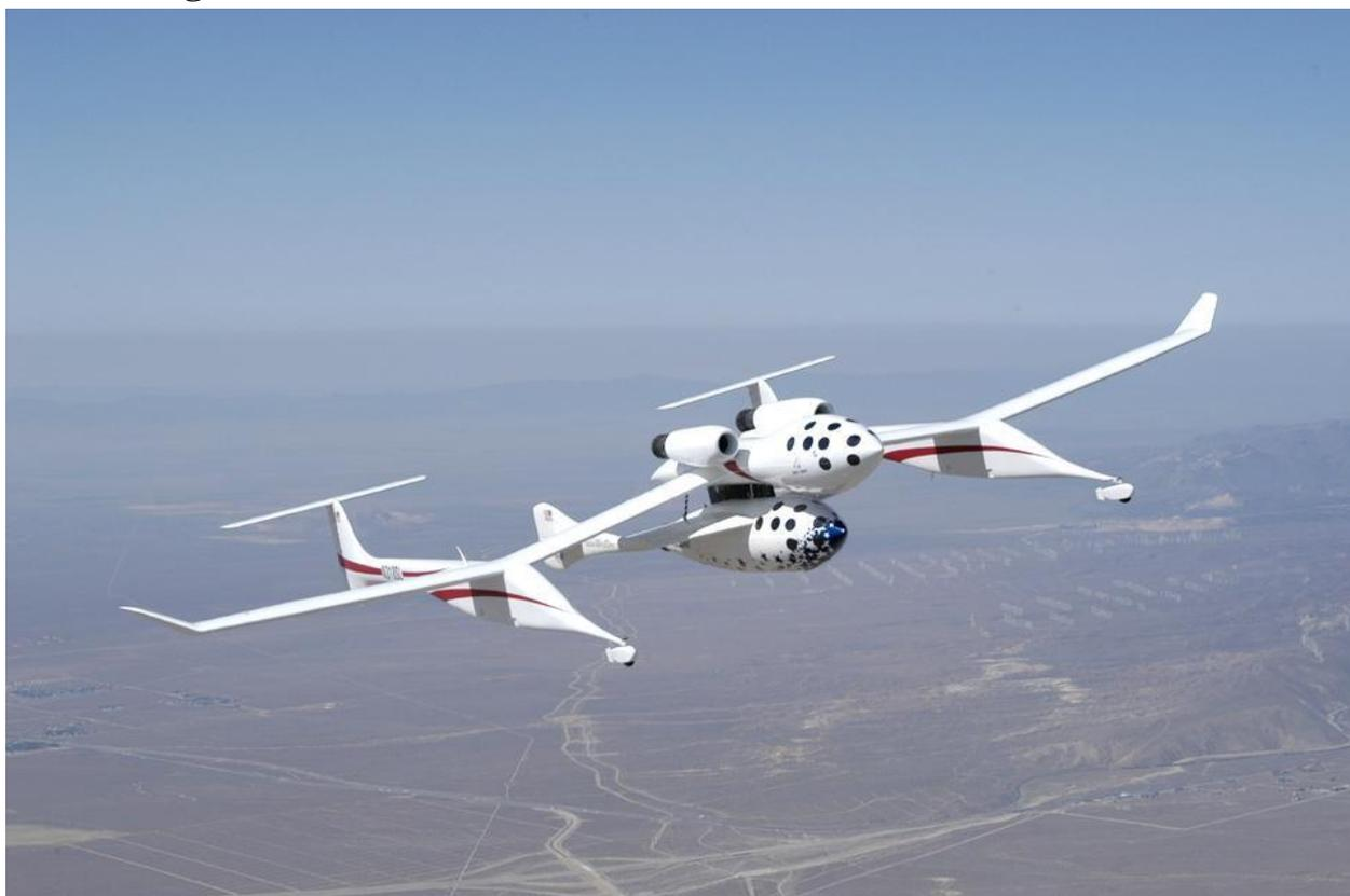
White Knight— единственный используемый в наше время летающий авианосец, спроектированный в качестве первой ступени суборбитального корабля SpaceShipOne. В начале полёта корабль поднимается на высоту примерно 14 км над уровнем моря при помощи специального самолёта WhiteKnight (Белый Рыцарь). Затем происходит отстыковка, выравнивается в течение примерно 10 секунд, а потом включается ракетный двигатель. Он
