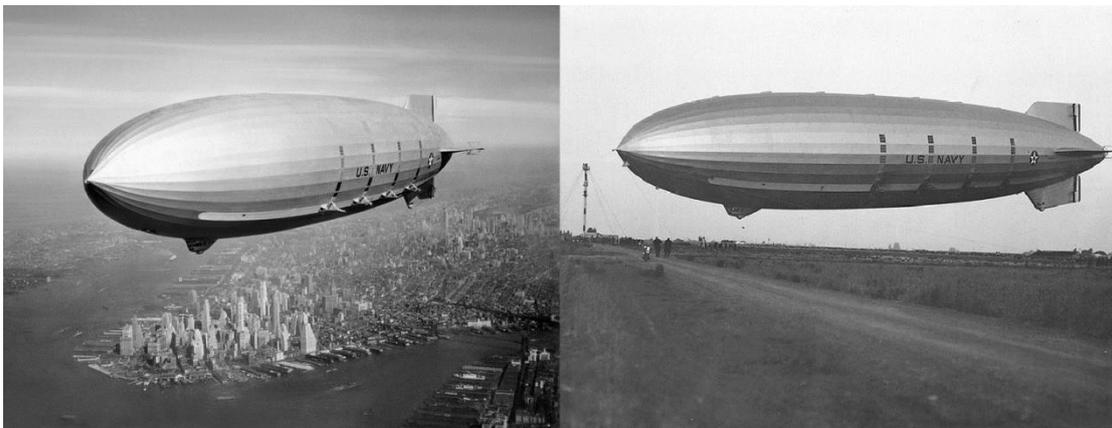
В межвоенный период были построены два самых крупных в истории летающих авианосца — специализированные дирижабли флота США «Акрон» и «Мэйкрон». Уступая объёмом лишь «Гинденбургу», эти воздушные корабли создавались как дальние разведчики, несущие на борту по 4 истребителя. Предполагалось, что при меньшей стоимости, дирижабли смогут эффективно заменять более дорогие крейсера.
