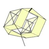
открылки. Он состоит из четырех продольных реек (лонжеронов) и четырех парных поперечных реек-крестовин, двух коробок и двух открылков.
