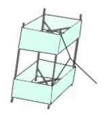
состоит из двух реек-распорок. Обтяжка змея изготавливается из двух полосок бумаги или синтетической ткани. Таким образом получаются две коробки — передняя и задняя. Змей данной конструкции был изобретен австралийским исследователем Лоуренсом Харгрейвом в 1893 году при попытках построить пилотируемый летательный аппарат.
